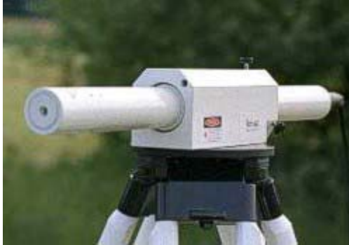
Foto 1. Fotografía de un scintillómetro. Permite obtener flujos de calor sensible (H) gracias a los cambios de intensidad de dos rayos láser polarizados provocados por diferencias de temperatura en el aire.
