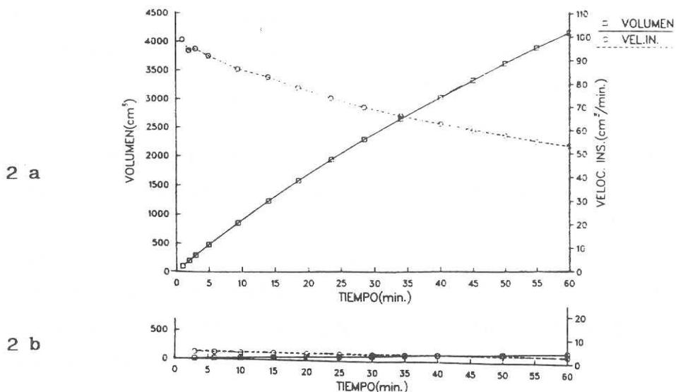
Figura 2. Valores de  $K_s$  instantánea durante la hora de medida. 2a. Muestra tratada con PVA1. 2b. Muestra testigo (T) no tratada.
