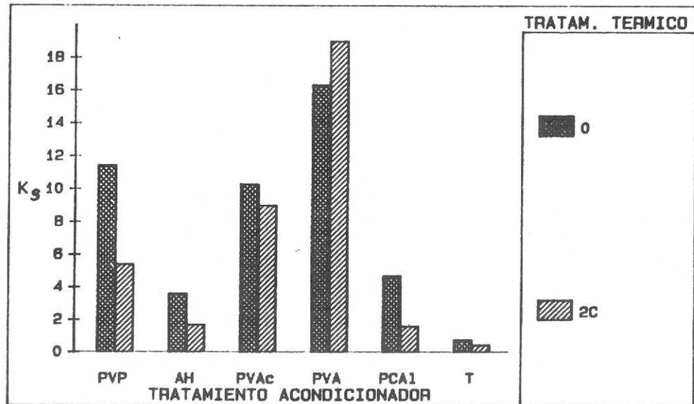
Figura número 1. Histograma de los valores de  $K_s$  en función del acondicionador y del tratamiento térmico (0 sin tratamiento térmico, 2C después de 2 ciclos). Para identificar los productos vease la tabla núm 1.
