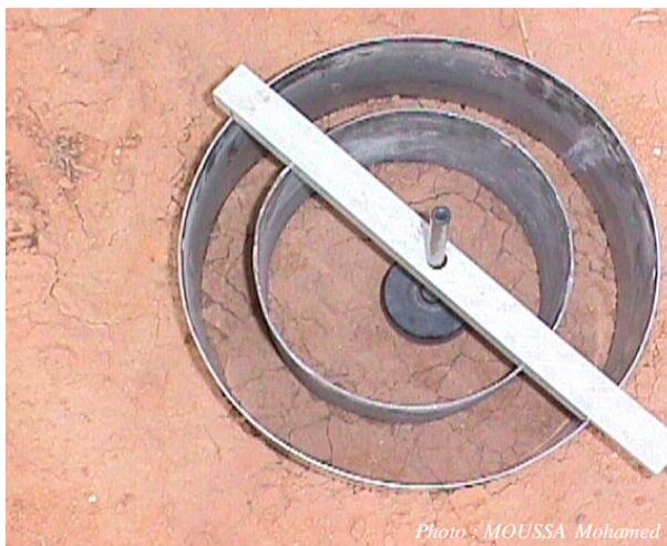
Figure 3.2 : Infiltromètre à double anneau
